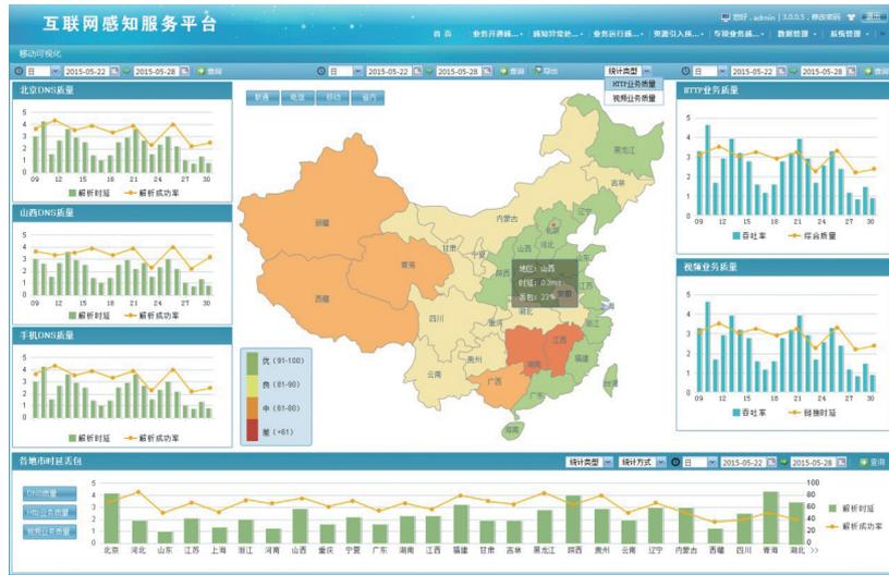
我們的NetVista平台的另一特色，是作為IP網絡性能故障診斷工具。透過全面的端到端IP網絡性能分析和管理，我們的NetVista平台提供任何兩個指定網絡節點之間的網絡層和應用層性能可視性。NetVista平台利用中心伺服器指示分佈在客戶（如網絡營辦商）網絡內各個關鍵位置的軟件代理及硬件代理，以進行各種端到端測試。NetVista平台的即時代理技術可以使標準網頁瀏覽器即時變成測試代理，從而大大縮短部署各代理於目標終端、故障診斷和修復所需的時間。NetVista平台在此功能方面的主要特點包括：
